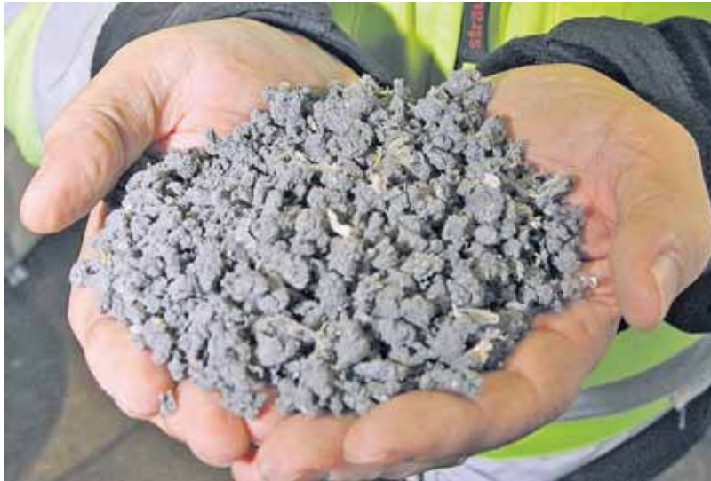
Dieses Kunststoffgranulat stellt die Eu-Rec her. Verwendet wird es zum Beispiel zur Herstellung von Autoteilen. TV-FOTO: ARCHIV/FRIEDEMANN VETTER
